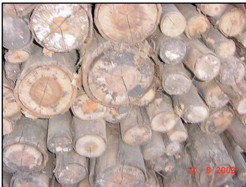
Foto 04 – Madeira com fungo
